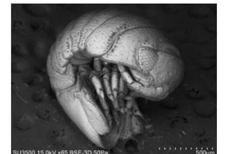
样品: 水虱 加速电压: 15kV, 真空: 50Pa 放大倍率: x65, BSE探测器 样品未作导电性处理
