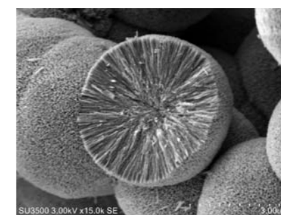
样品: 二氧化钛颗粒 加速电压: 3kV, 放大倍率: x15,000 样品未作导电性处理 样品提供: 由东北大学 垣花真人 先生
